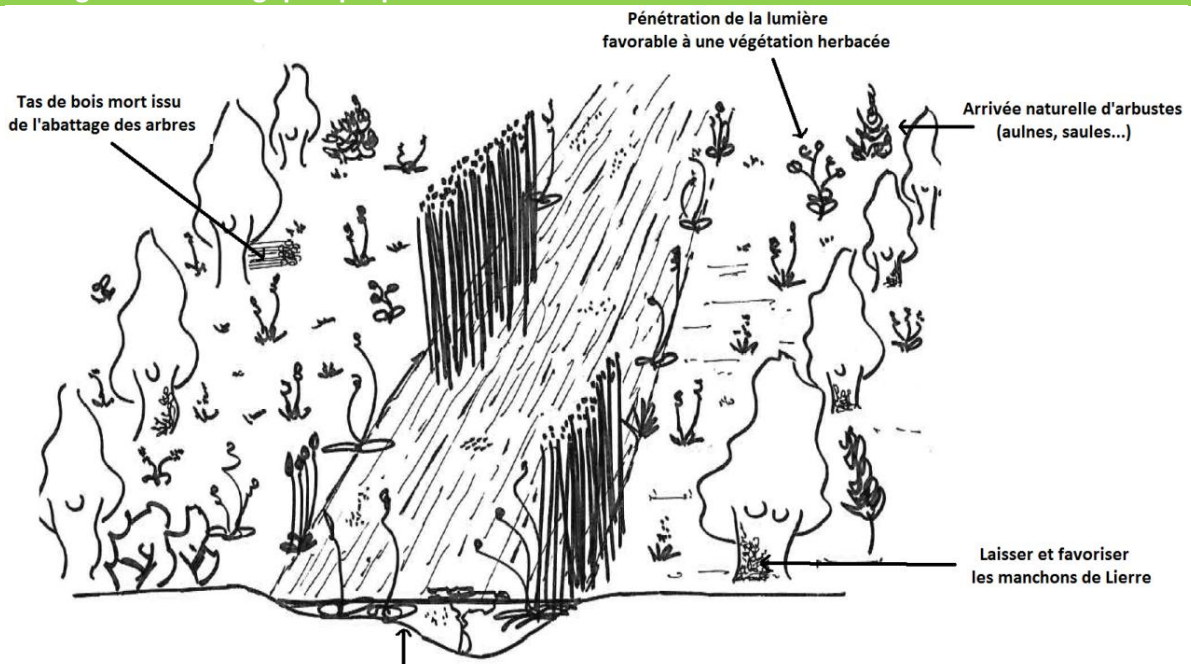
Abattage de Peupliers du Canada d'où remontée de la nappe d'eau douce de surface et possibilité de creuser mares, zones humides et autres noues écologiques de rétention d'eau. Installation d'une végétation aquatique et subaquatique (roselières, cariçaies, mégaphorbiaies...). Favoriser les niches écologiques en jouant sur les profondeurs des zones humides créées.
